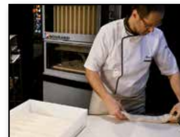
▶▶ 9) Osázení dílků na osazovací pás pece
